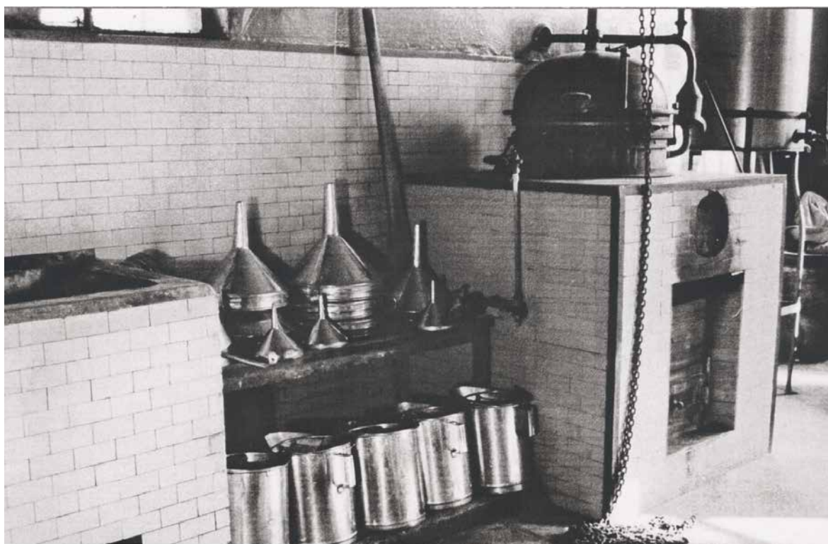
罗西酒厂 上图：水浴式蒸馏器。下图：19世纪下半叶，公司第一台蒸馏器的技术细节。
